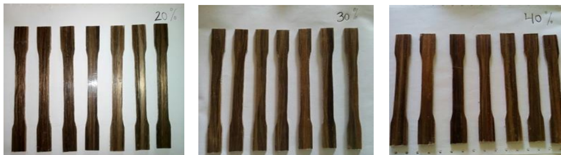
Gambar 2. Spesimen uji tarik fraksi volume 20%, 30% dan 40%.
